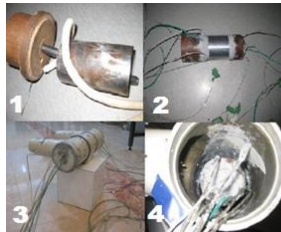
شکل ۱- مراحل ساخت تیوب آزمایشگاهی (المنت (۱)، محافظ آلومینیومی (۲)، محفظه روغن دور تیوب (۳) و ترموکوپل ها (۴))
