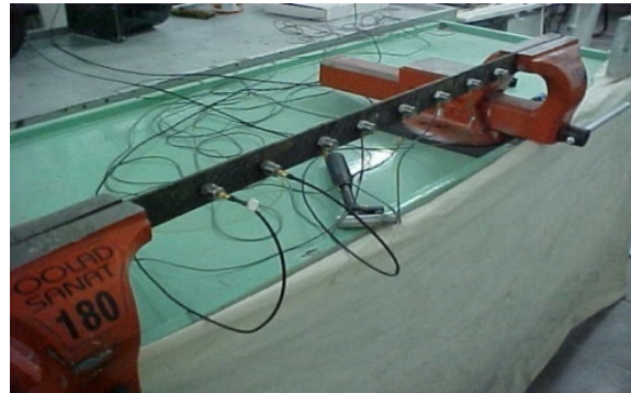
شکل ۱۲- نمایی از تیر دو سر درگیر تحت تست
